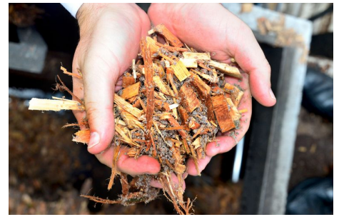
Biomasseabfälle von der Waldwirtschaft wird mit Schlamm des fabrikeigenen Produktionsprozesses gemischt.
